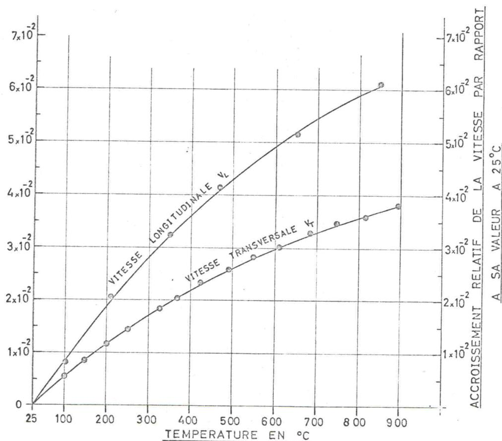
Fig. 1. — Variation des vitesses de propagation des ultrasons avec la température dans la silice fondue à  $\sim 16$  MHz.
